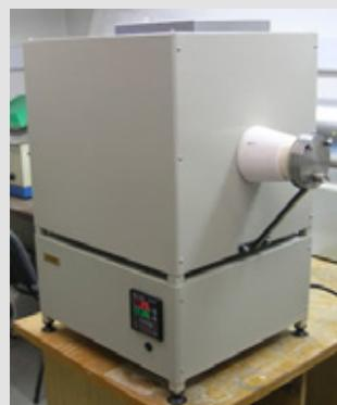
kovov a keramiky. Pec možno používať do maximálnej teploty 1200°C. Výhrevné špirály z Kanthalu A1 sú zavesené na keramických trubkách. Regulátory zabezpečujú v programovateľnej verzii presnosť ±3°C pri optimálnom nastavení regulácie a výkonu.
